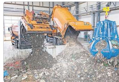
Maximal können zwei Lkw gleichzeitig den Inhalt der Biotonnen anliefern. Ein ausgefeiltes Störstoffmanagement gewährleistet die Sortierung bereits bei der Annahme. Durch die aufwändige Aufbereitung werden störende Stoffe wie Glas, Metall und Kunststoffe zuverlässig herausgefiltert. Fotos: REHAU AG
